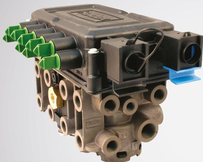
**Módulo EBS para semirremolques y remolques de ejes centrales. El módulo EB+ Gen3 2M, integra 2 moduladores, 4 sensores, múltiples conexiones de auxiliares, función de antivuelco y máxima flexibilidad.**
