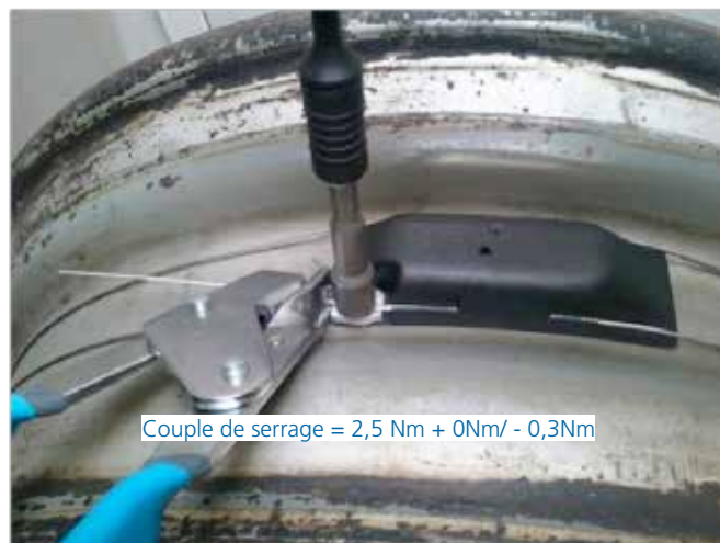
Position de l'opérateur lors de l'installation
