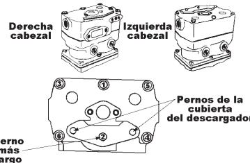
1. Retire los seis (6) pernos del cabezal 3/8-16 UNC.
